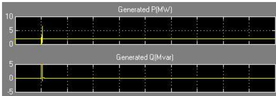
Hình 16 - Giản đồ kết quả mô phỏng với lỗi ngắn mạch một pha trên lưới 22 kV ở chế độ ổn định điện áp
