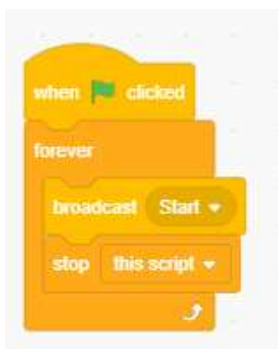
Hình 2.3.3. Dừng phát thông báo start nhiều lần bằng câu lệnh stop this script
