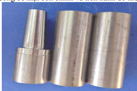
Hình 3.5. Hình ảnh phôi thép SUS304 trước và sau khi gia công bề mặt côn để kiểm tra độ nhám
