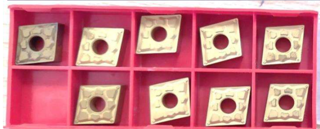
Hình 3.3. Phần cắt của dao dùng để gia công mẫu thí nghiệm
