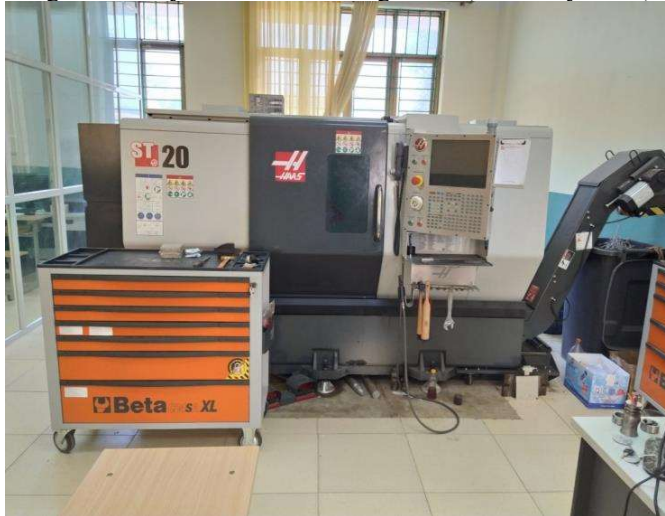
Hình 3.1. Máy tiện CNC mã hiệu HAAS – ST20
