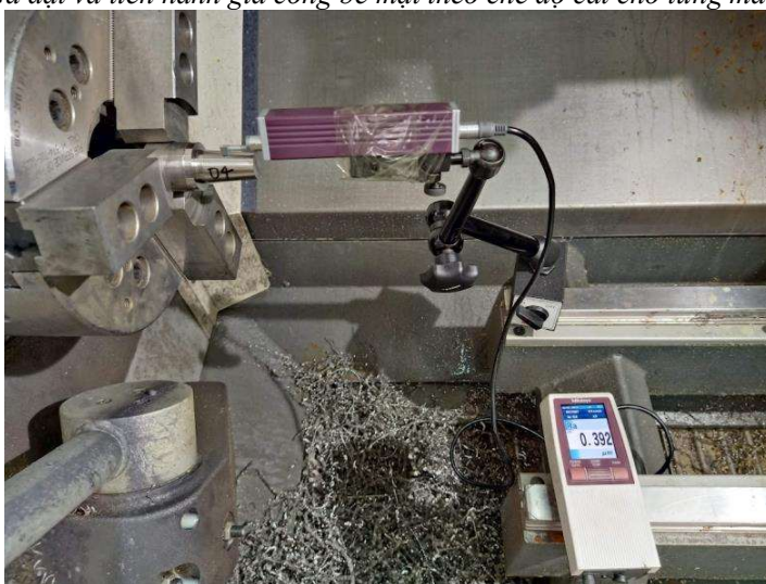
Hình 3.7. Hình ảnh quá trình đo kiểm tra độ nhám trực tiếp cho từng mẫu thí nghiệm bằng máy đo độ nhám cầm tay sau khi gia công xong
